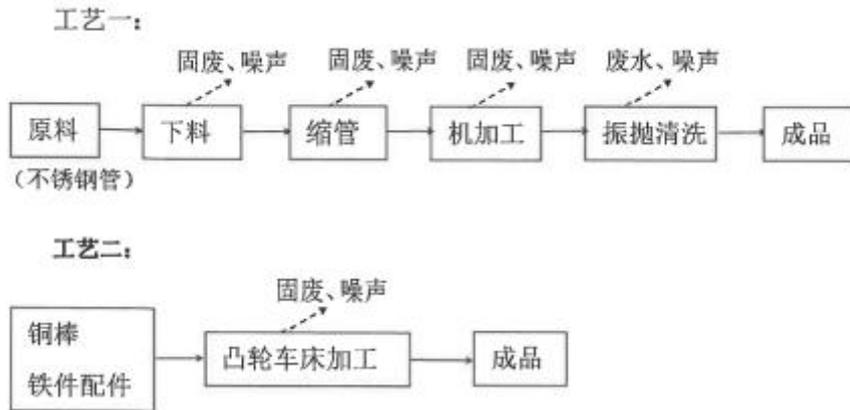
图 2-1 本项目生产工艺流程及产污环节
