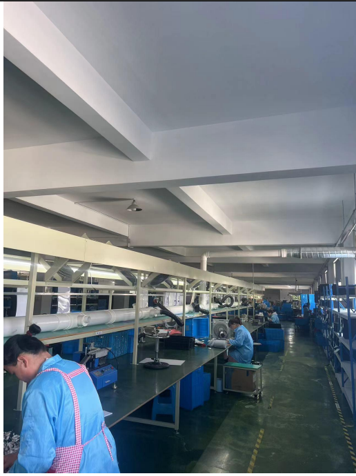
补焊流水线锡尘收集
