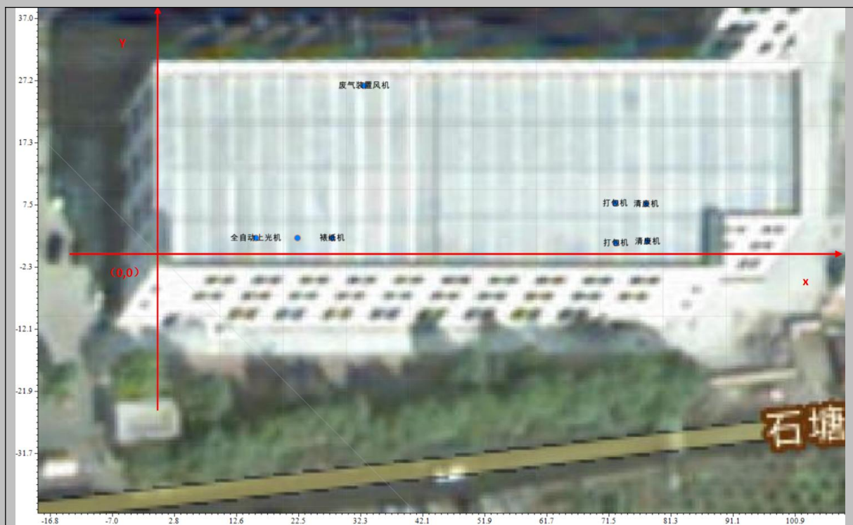
图 4-3 企业二层及楼顶各声源坐标图
