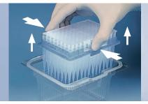
同时捏住移取工具的长边并保持,取出吸头托架。 确保移取工具的卡点出于正确的 位置。
