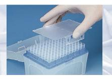
将移取工具拿走。完成! —— 所有步骤无需接触吸头!
