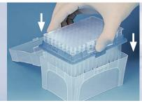
将预装吸头的吸头托架垂直地自 上而下插入一个灭过菌的空吸头 盒,直至其卡入正确的位置。
