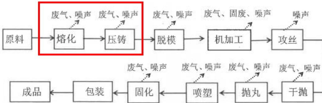
图 2-1 本项目生产工艺流程及产污环节（红框内工序为本阶段验收工序）
