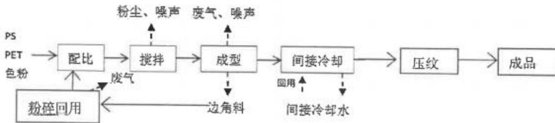
图 2-1 本项目工艺流程及产污环节
