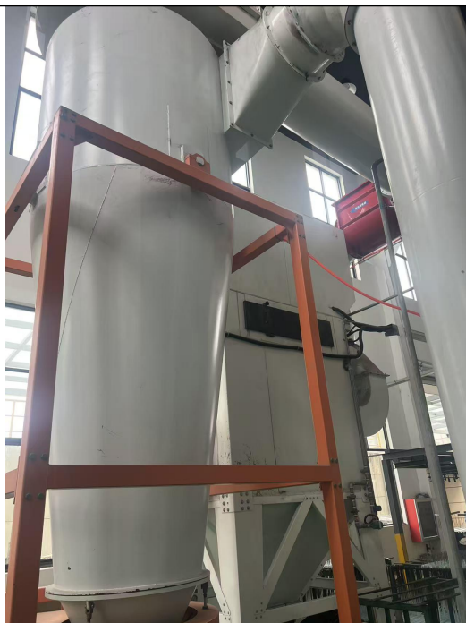
旋风过滤收集+脉冲布袋除尘器
