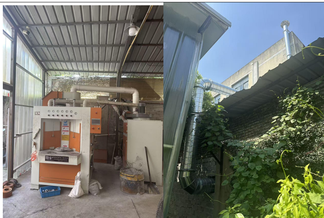
喷砂机自带布袋除尘装置
