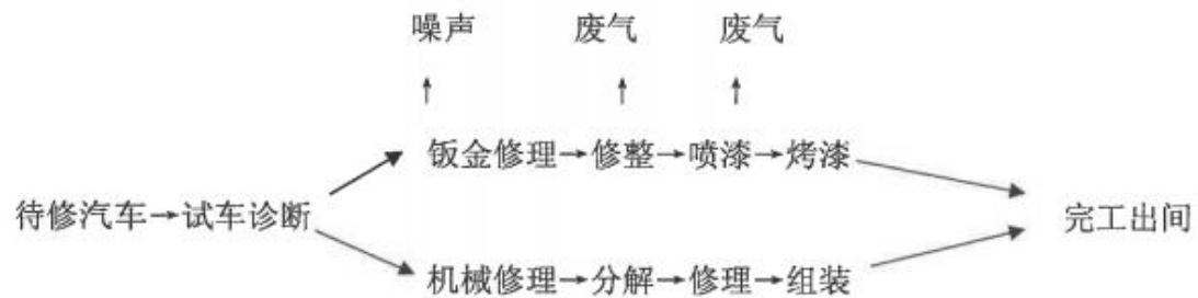
图 2-1 汽车维修工艺及产污节点图
