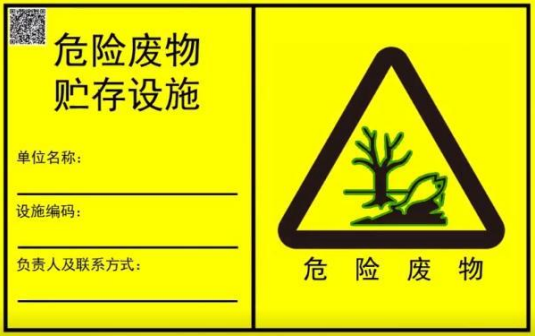
图4.5-4 危险废物贮存设施标签
