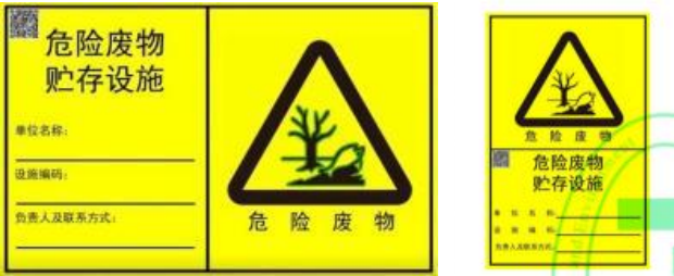
图 4-7 危险废物贮存设施标签
