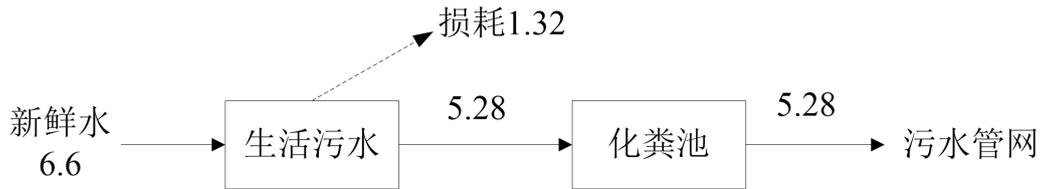
图 2-1 项目水平衡图 单位： $\text{m}^3/\text{d}$
