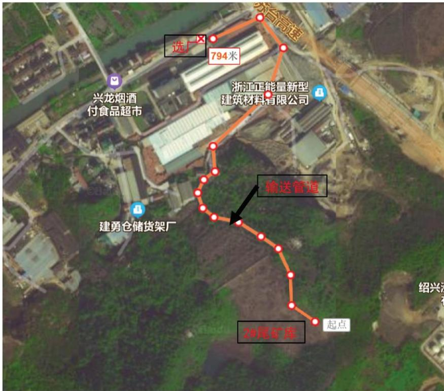
图 2-4 2#尾矿库输送管道走向示意图
