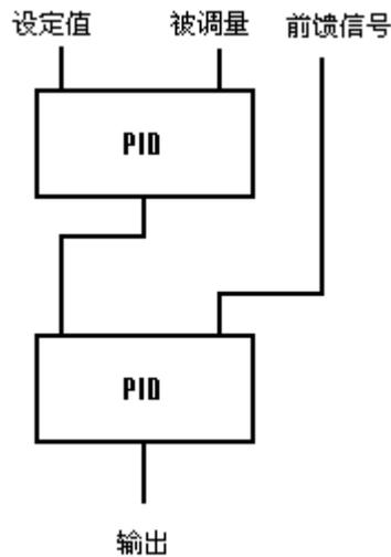
也有人会说：前馈信号到底能带来多大干扰，需要对干扰情况进行调节的。这个问题在副调的PID 调节器内就可以解决。修改比例带的大小就可以解决。不过也有很多人倾向于给副调的测量值加上一个系数。也行。控制策略原理框图如下所示：
