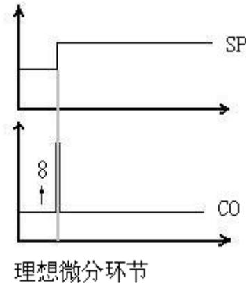
然后把运算的结果叠加到 PID 的输出，去控制执行机构。使用微分导前而不使用串级调节系统，有它特殊的地方。目前，许多人对于到底是用微分导前还是串级很迷惑，这个问题在下一章我们会讲到。这里暂略不表。
