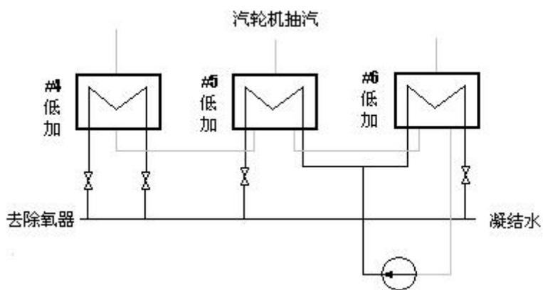
孔板测量，需要寻找一个数米长的直管段，拥挤的汽机空间不一定能够找到这么一个直管段；还需要投入一定的费用购买流量孔板和变送器。所以往往许多厂矿没有流量测量装置。那么，我们可以让#4 低加输水的执行器反馈作为#5 低加水位的前馈信号，虽然不太好，将就着用吧。控制策略原理框图如下：
