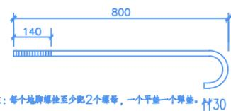
注：每个地脚螺栓至少配2个螺母，一个平垫一个弹垫。H30
