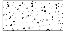
水泥混凝土面层
